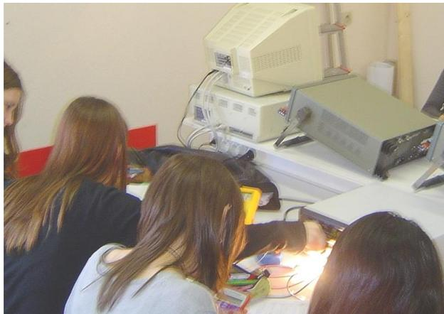
Dans un premier temps, en utilisant leurs connaissances de physique et de mathématiques, les élèves ont réalisé des mesures simples d'électricité (tension et intensité), calculé la résistance du filament d'une lampe à incandescence, et à partir d'un graphique, déterminer la température de celui-ci.
